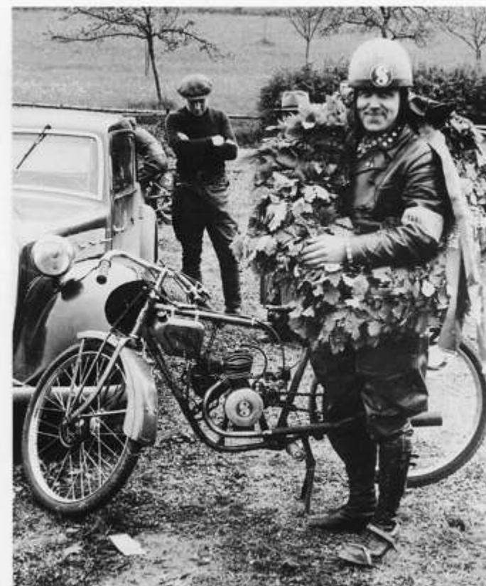
Und wieder ging ein Lorbeerkranz an Willi Schreiber. Wegen der Ladepumpe hängt der kleine Motor recht weit oben im Rahmen des Express-Motorfahrrads. Das Sachs-Logo prangt prominent auf Helm und Motor, Unterstützung vom Werk gab's trotzdem nicht
