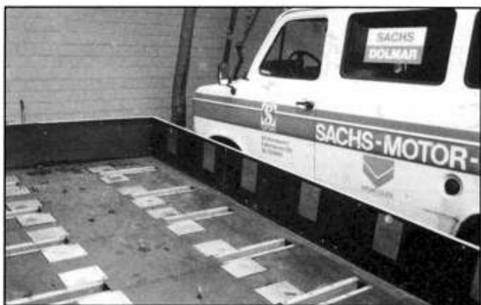
Dieser Spezialanhänger, auf dem die Mofas einfach in die in den Boden eingelassenen Schlitze gestellt werden, pendelt zwischen der BASF und Sachs-Motor-Schreiber.
